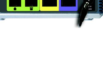
G Ligue o transformador fornecido à porta de alimentação do Gateway de voz e, em seguida, ligue o transformador a uma tomada. O LED de alimentação do painel frontal acender-se-á quando o Gateway de voz for ligado.
