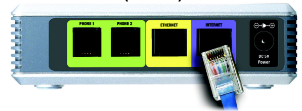
Figur 4-3: Tilslutning til internetporten
