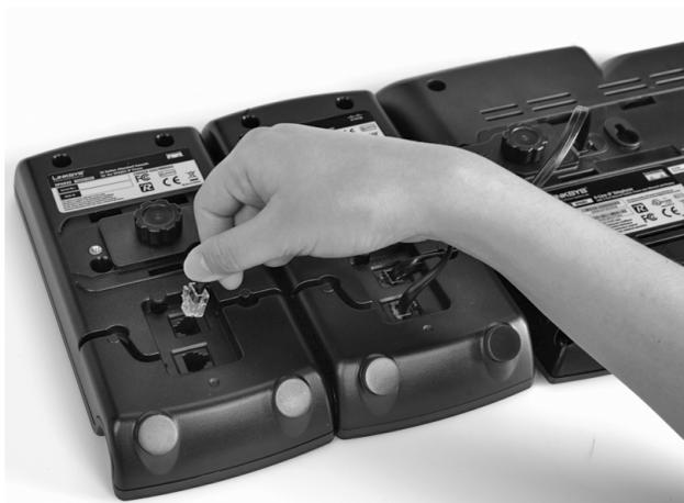
**G** Legen Sie das Zusatzkabel in die Kabelführung ein.
