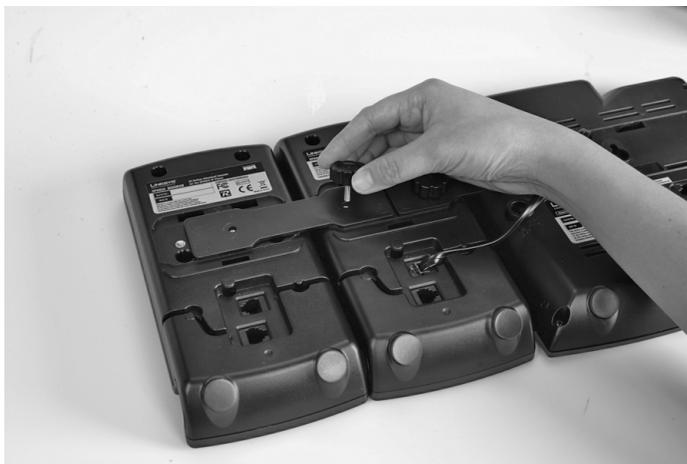
**C** Legen Sie das Loch in der Ausrichtungsvertiefung der zweiten SPA932 und das Loch im Anbauteil übereinander.
