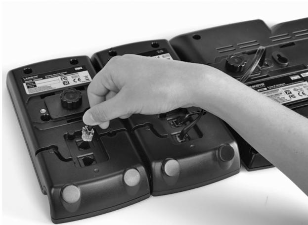
**G** Coloque el cable auxiliar dentro del canal de acoplamiento del cable.
