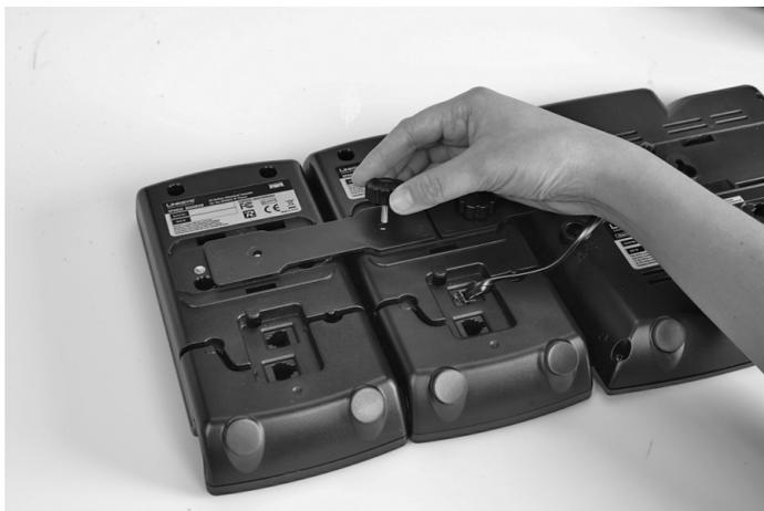
**C** Alinee el orificio del hueco de alineación del segundo SPA932 con el orificio del brazo de acoplamiento.
