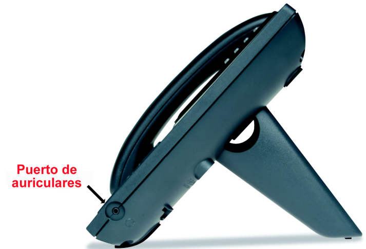
Figura 2-2: base de escritorio fijada al teléfono (paso 5)
